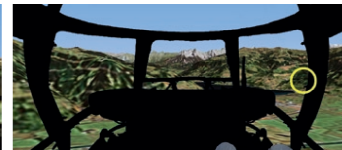
Am Rande des Blickfelds: Aus dem Katana-Cockpit (l.) ist der Hubschrauber nach einer Rekonstruktion der Unfall Experten kaum zu erkennen, zeitweise wird er durch das Panel verdeckt. In der Heli-Kanzel (r.) behindert der Türrahmen die Sicht auf den Tiefdecker
