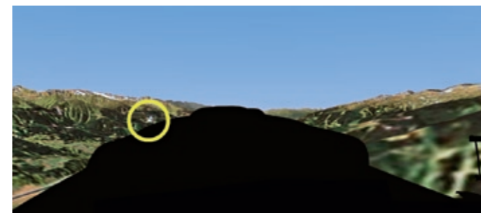
Am Rande des Blickfelds: Aus dem Katana-Cockpit (l.) ist der Hubschrauber nach einer Rekonstruktion der Unfall Experten kaum zu erkennen, zeitweise wird er durch das Panel verdeckt. In der Heli-Kanzel (r.) behindert der Türrahmen die Sicht auf den Tiefdecker
