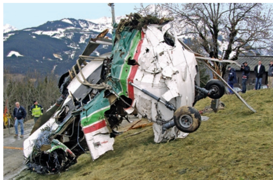
Bild der Zerstörung: Kabine und Heckausleger des Hubschraubers sind hinter dem Cockpitdurchgang von der Pilotenkanzel abgerissen (oben). Die Unfallmuster: ASS 332 »Super Puma« (links) und DV 20 Katana (links außen), hier zwei baugleiche Maschinen
