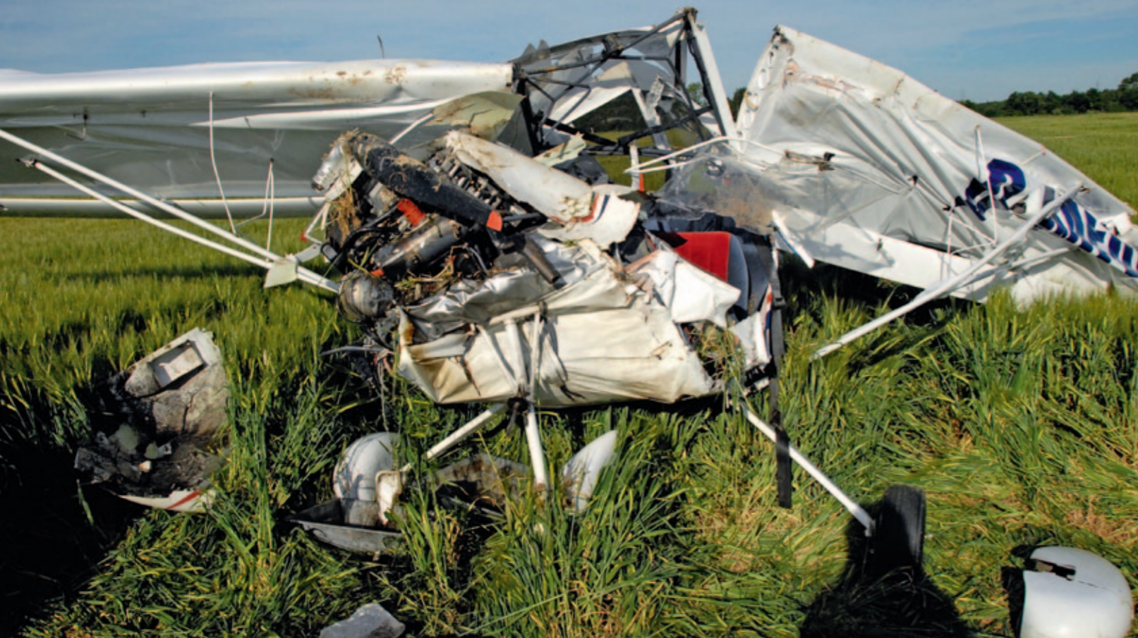
Schwierige Spurensuche: Der Eurofox ist so stark zerstört, dass die BFU nicht mehr feststellen kann, ob es einen Defekt am Auspuff gab
