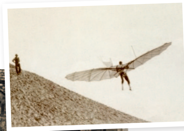
Limit erkennbar: Im Gerät auf die Unterarme gestützt kann Lilienthal seine Körpermasse nur bedingt auslenken und damit zum Steuern einsetzen
