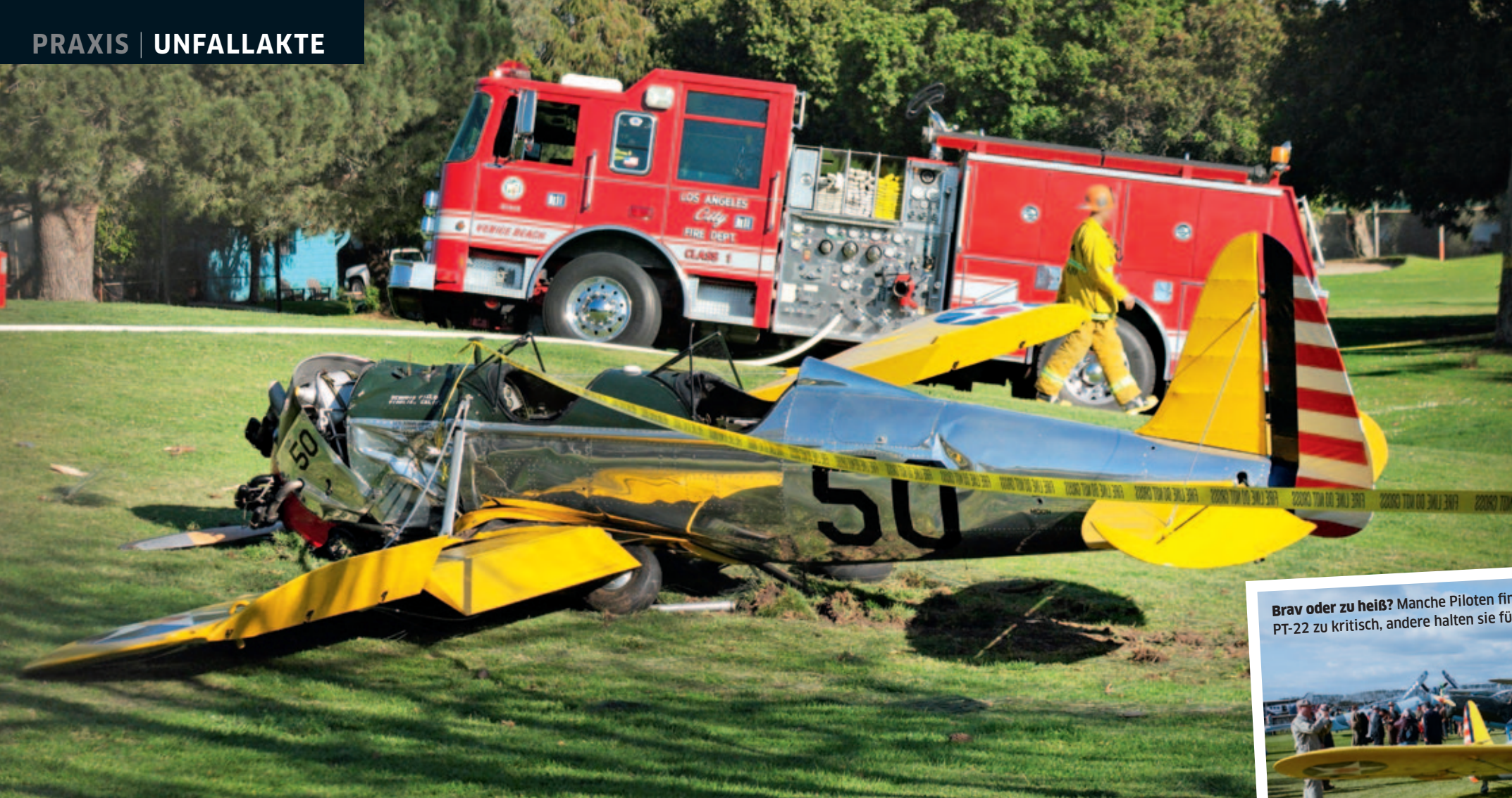
Bruchgelandet: Der Rumpf der PT-22 bleibt weitgehend intakt, doch der Pilot verletzt sich schwer am Kopf – die Halterungen des Schultergurts versagten
