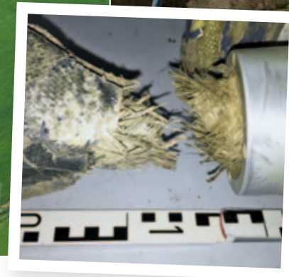
Spurensuche: Das beim UL gefundene Propellerblatt ist abgebrochen; das fehlende Blatte ist dagegen abgerissen
